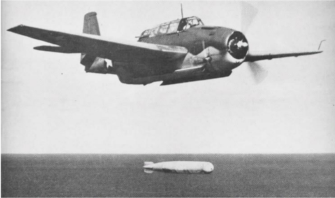
A TBF-1 Avenger dropping a torpedo.
